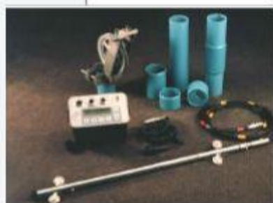
sonda de inclinómetro con el equipo de lectura y registro de datos digital DATAMATE, tubería y accesorios.
