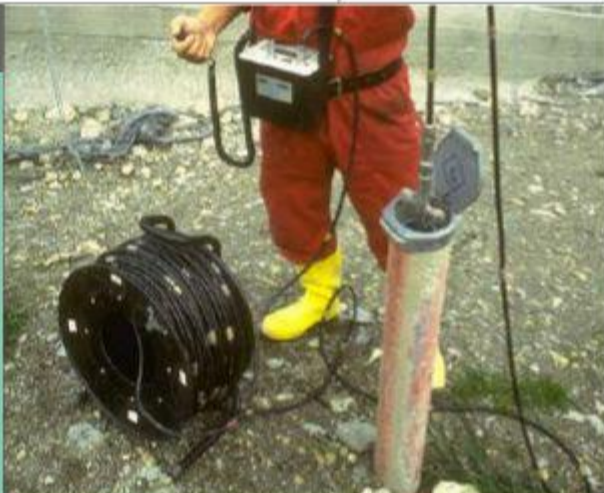
mediciones en terreno con un inclinómetro
