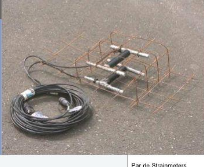
Par de Strainmeters SSM1 para shotcrete listos para instalación
