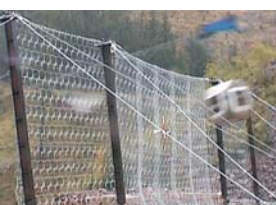
Test del sistema de protección contra caída de rocas
